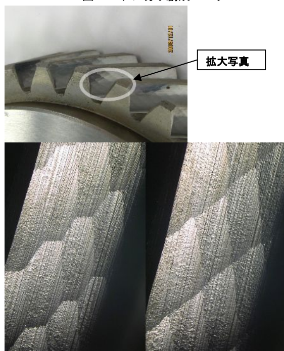
ダイアゴナルホブ切りの歯面 通常ホブ切りの歯面 写真8 歯面の拡大写真
